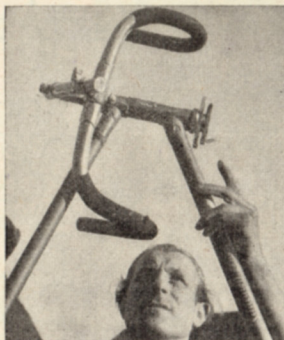
Materialfehler? Fachleute meinen zu den weggebrochenen Gabelenden an Mirkes Rad: „Wenn man zwei Jahre mit einer Maschine fährt, kann das Material müde werden.“
